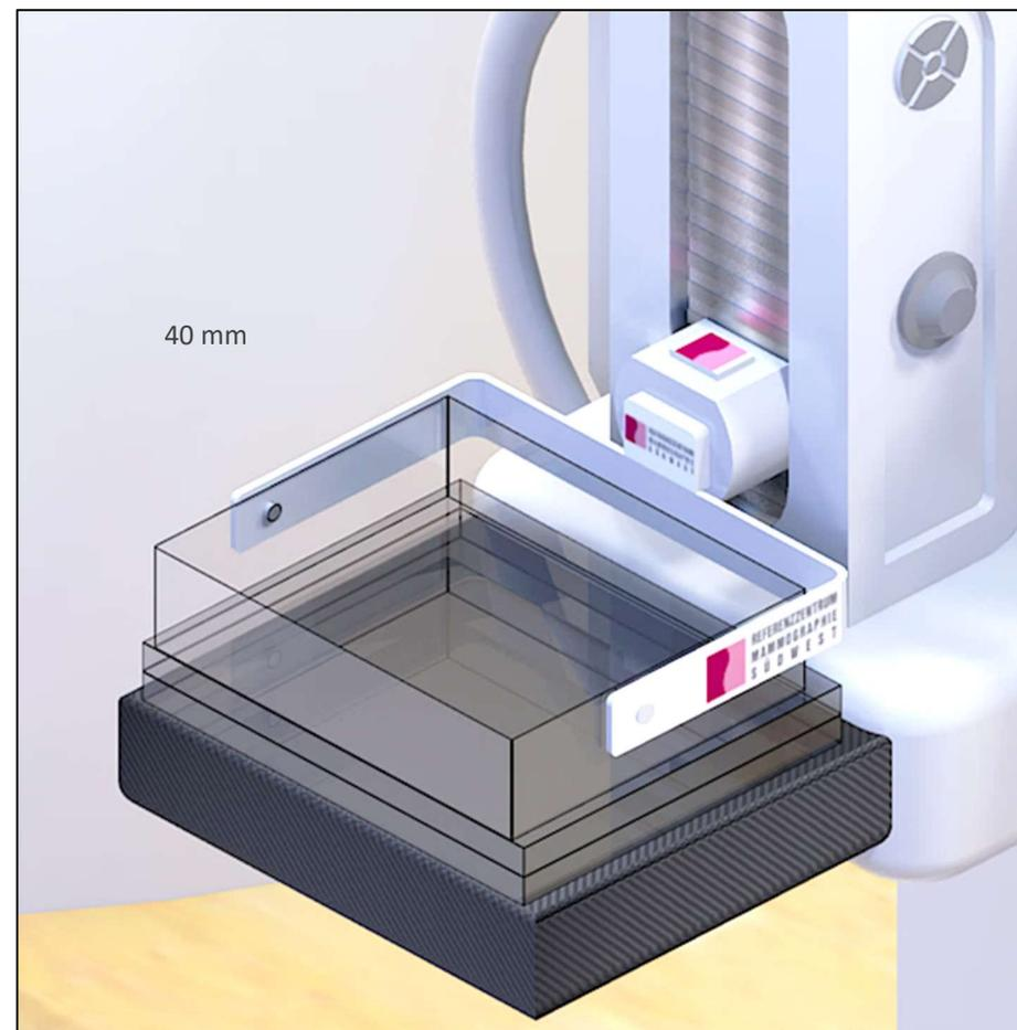
Abbildung 1: Prüfaufbau - 6.2 Belichtungsautomatik und 6.3 Störstrukturen 40 mm PMMA; Aufnahme mit Belichtungsautomatik (TKP-Aufnahme Nr. 1 von 1) Schrägansicht
