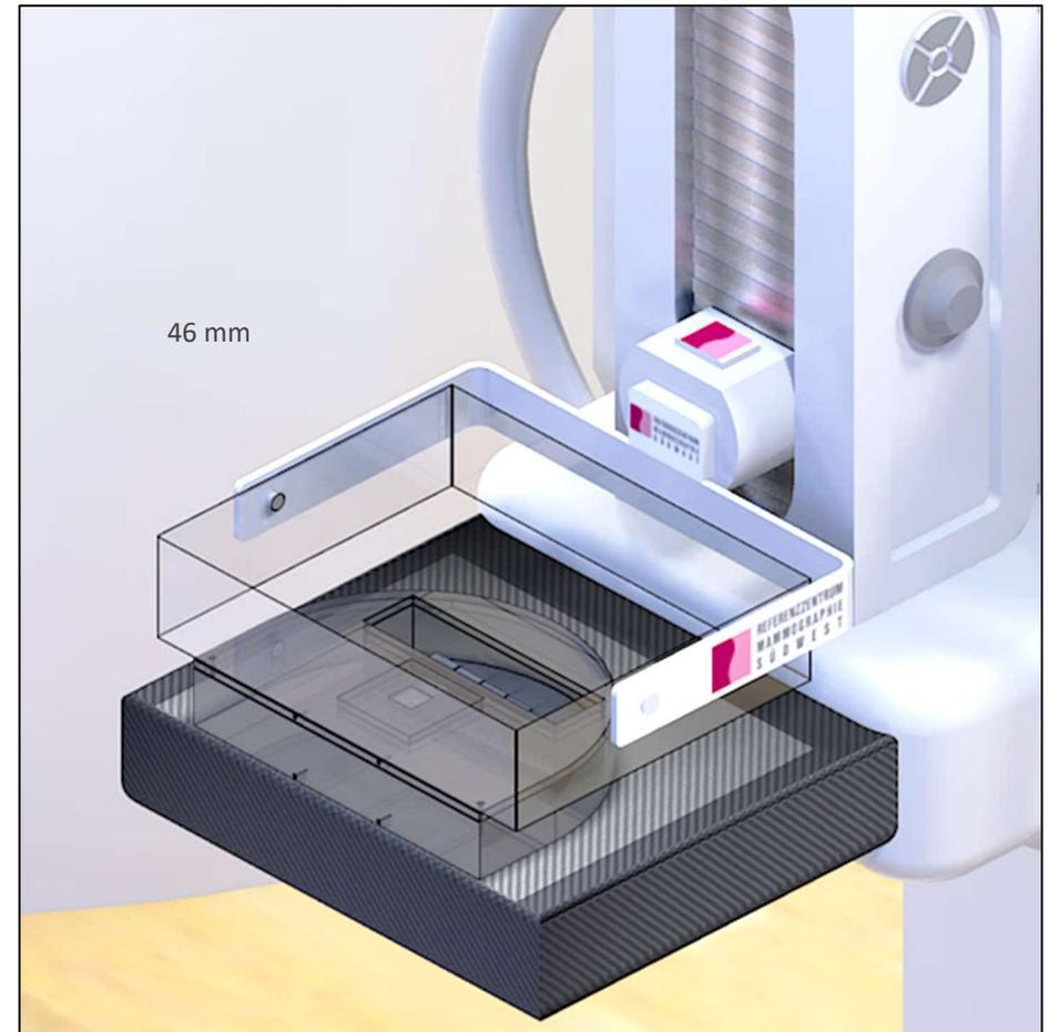
Abbildung 3: Prüfaufbau - 7.4 Dynamikumfang und 7.5 Thoraxwandseitiger Bildverlust (MKP-Aufnahme Nr. 4 von 5) 40 mm Grundkörper mit 6 mm Strukturplatte inkl. Testeinheit PMMA Schrägsicht
