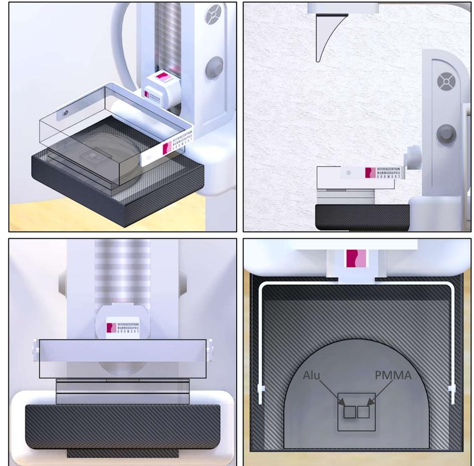
Abbildung 6: Prüfaufbau - 7.3 Signaldifferenz-Rausch-Verhältnis, hier exemplarisch für 46 mm PMMA
