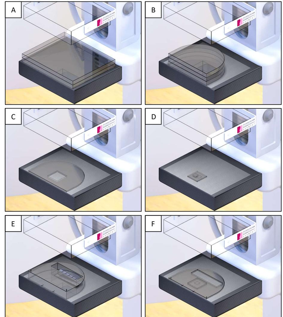
Abbildung 10: Regelmäßig benötigte Prüfkörper für die Durchführung der arbeitstäglichen und monatlichen Konstanzprüfung
