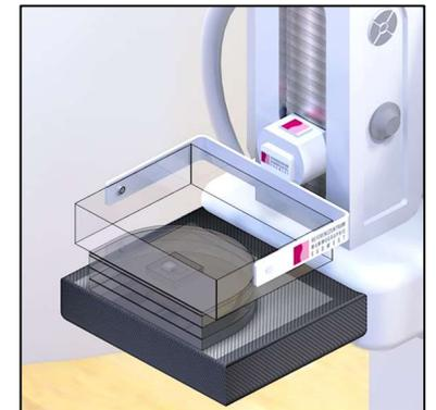
Abbildung 7: Prüfaufbau - 7.3 Signaldifferenz-Rausch-Verhältnis: 26 mm, 46 mm und 66 mm PMMA inkl. Testeinsatz SDNR; jeweils in Seiten-, Front- und Schrägansicht
