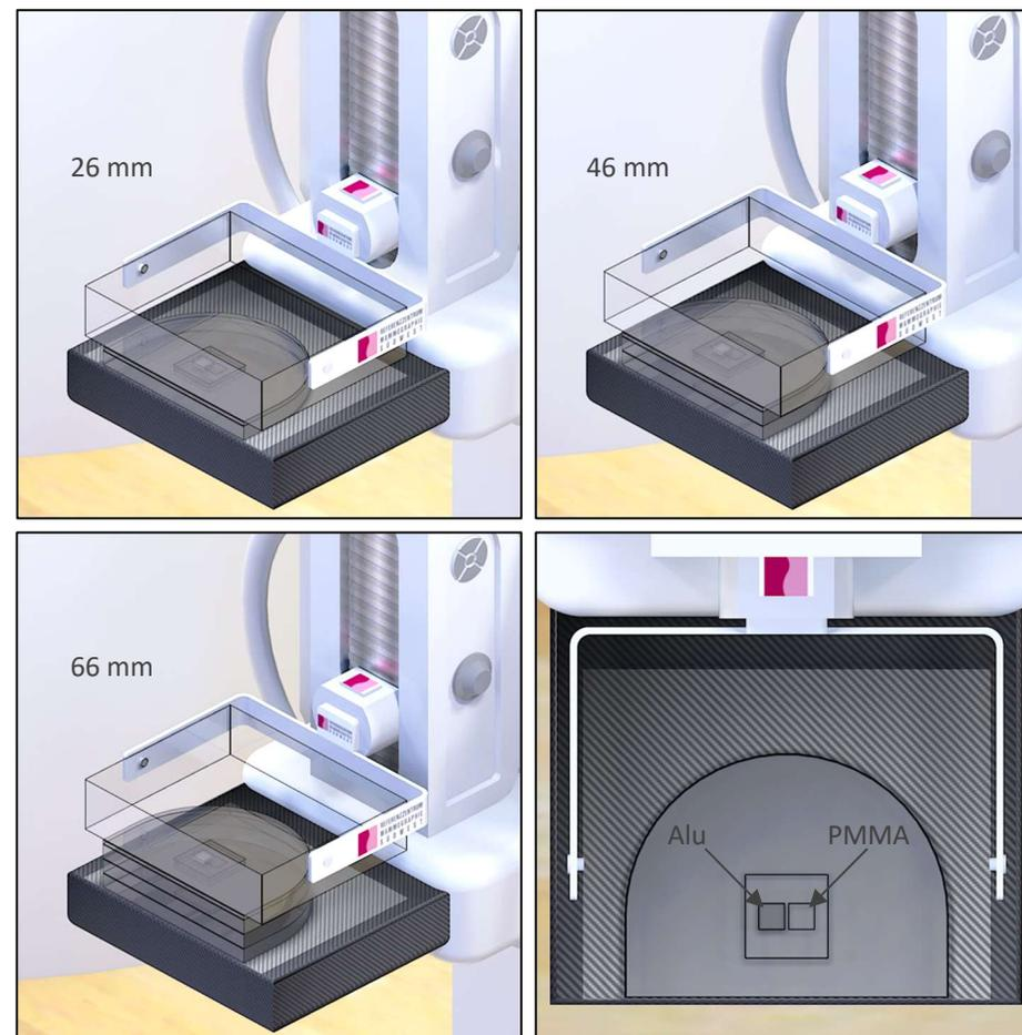
Abbildung 2: Prüfaufbau - 7.3 Signaldifferenz-Rausch-Verhältnis (MKP-Aufnahme Nr. 1 bis 3 von 5)
